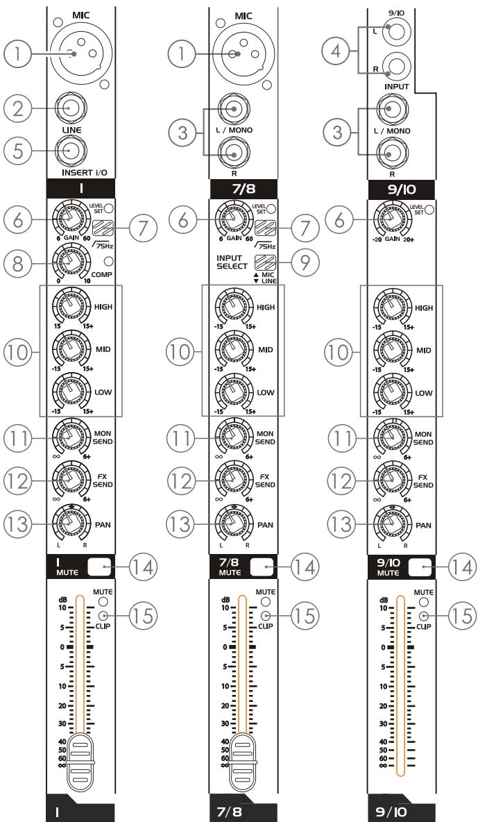
**1. MIC** - микрофонный вход, обеспечивающий балансное подключение микрофона через XLR-разъём, а также оборудованный переключаемым источником фантомного питания (48 В) для конденсаторных микрофонов. Предусилители студийного качества дают чистый гейн без искажений и помех, что обычно получается только с дорогостоящими внешними предусилителями.
