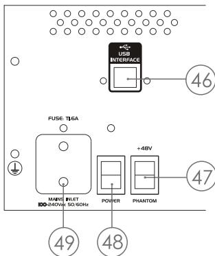
**46. USB INTERFACE** – порт USB тип "A" для подключения к компьютеру для использования микшерного пульта в качестве звуковой карты со стереовходом и стереовыходом. Стереосигнал с компьютера поступает на фейдер USB (36), а в компьютер поступает сигнал основного микса, регулируемый фейдерами основного микса (41).
