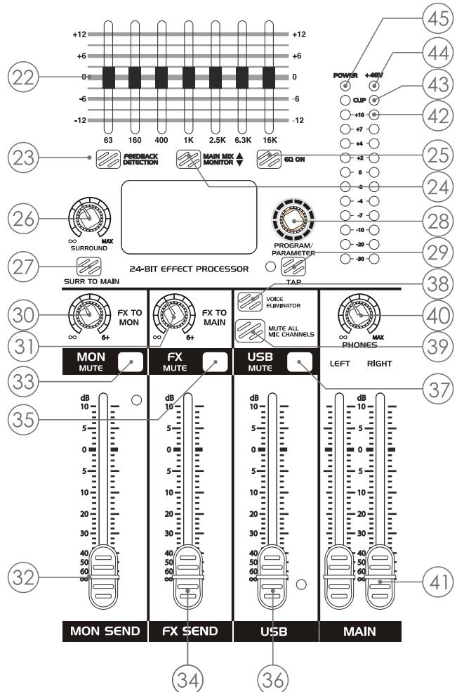
**22.** 7-полосный мастер эквалайзер для частотной коррекции мониторного или главного микса.
